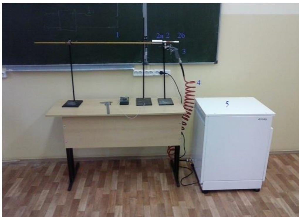
Рис. 2. Фото установки с внутренней системой очистки и осушения воздуха
