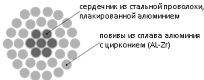
Рис. 1. Разрез высокотемпературного провода
