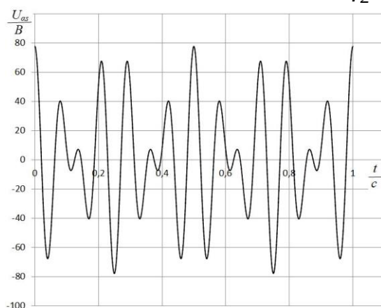
Рис. 16. Напряжение статорной обмотки по оси \alpha при амплитудной модуляции с U_1 = U_2 = 55 \text{ В} , f_1 = 12 \text{ Гц} , f_2 = 10 \text{ Гц}
