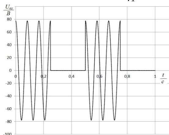
Рис. 11. Напряжение статорной обмотки по оси \alpha при фазовой модуляции с U_1 = U_2 = 55 \text{ В} , f_1 = 12 \text{ Гц} , f_2 = 10 \text{ Гц}
