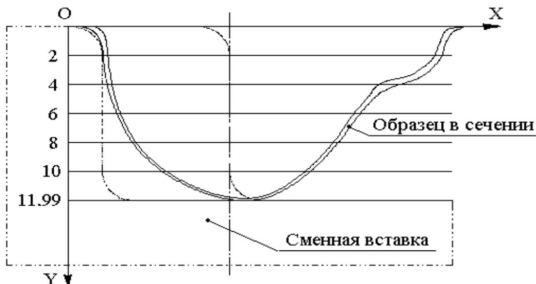
Рис. 3. Результаты размерного анализа одного из опытных образцов асимметричной формы сечения
