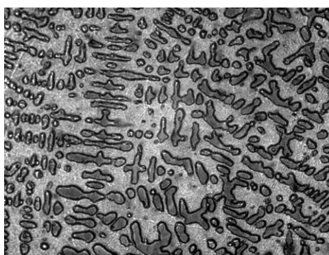
Рис. 2. Микроструктура сплава Г61Д27Н2Ж2ЮЦр после полировки и травления, x250
