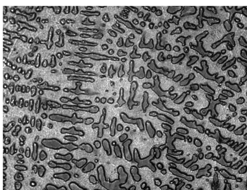
Рис. 2. Микроструктура сплава Г61Д27Н2Ж2ЮЦр после полировки и травления, х250
