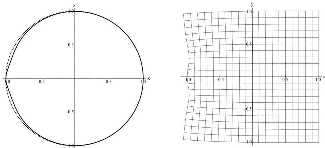
Рис. 5. Граница области (слева) и искажение координатной сетки (справа) для варианта 5 при  $\varepsilon = 0,01$  и  $a = 0,7$
