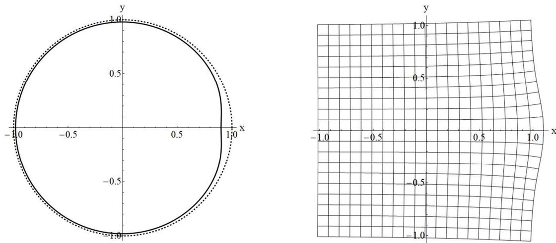
Рис. 1. Граница области (слева) и искажение координатной сетки (справа) для варианта 1 при  $\varepsilon = 0,03$  и  $a = 0,7$
