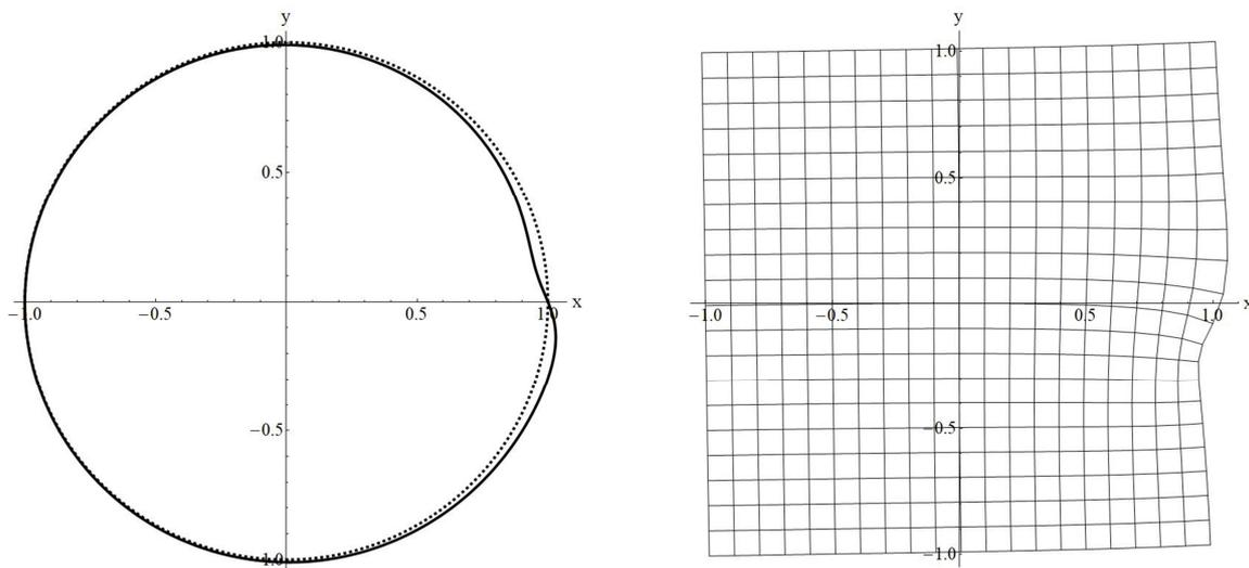
Рис. 2. Граница области (слева) и искажение координатной сетки (справа) для варианта 2 при  $\varepsilon = 0,02$  и  $a = 0,8$
