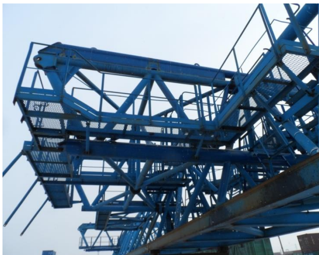
а – соединение ригеля жесткой опоры с мостом крана
