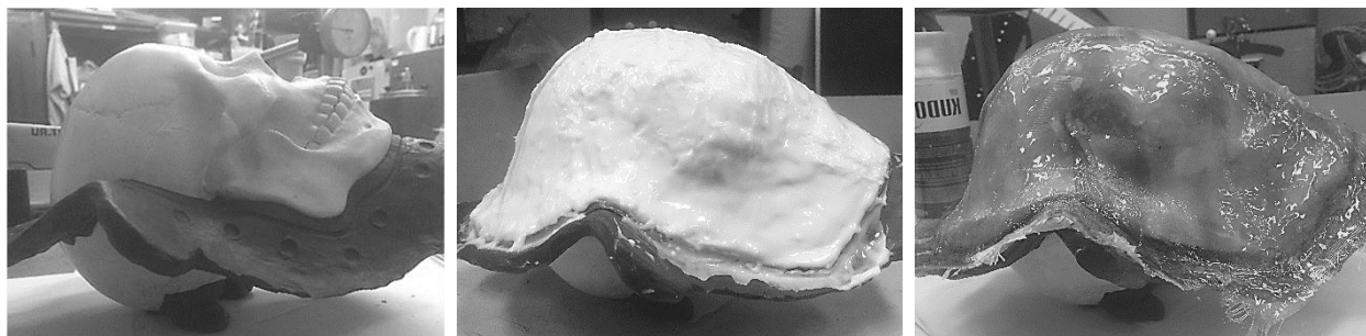
Рис. 1. Этапы изготовления эластичной формы
