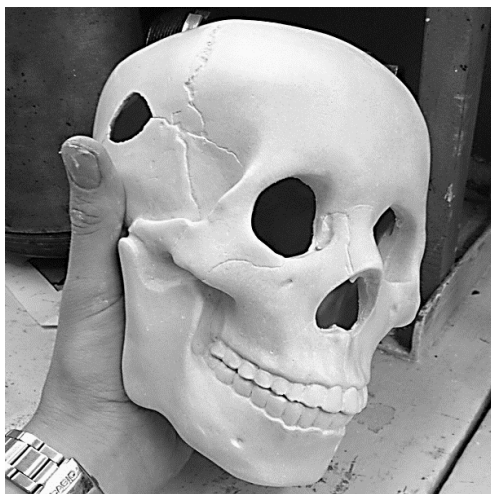
Рис. 3. Брак при малом объеме заливаемой смеси
