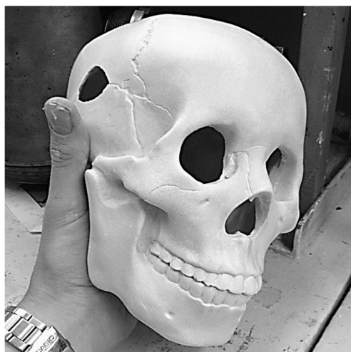
Рис. 3. Брак при малом объеме заливаемой смеси
