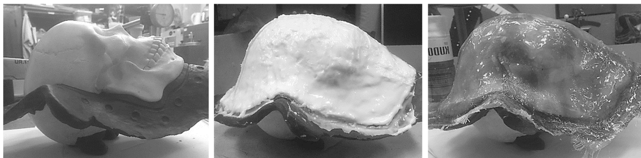
Рис. 1. Этапы изготовления эластичной формы
