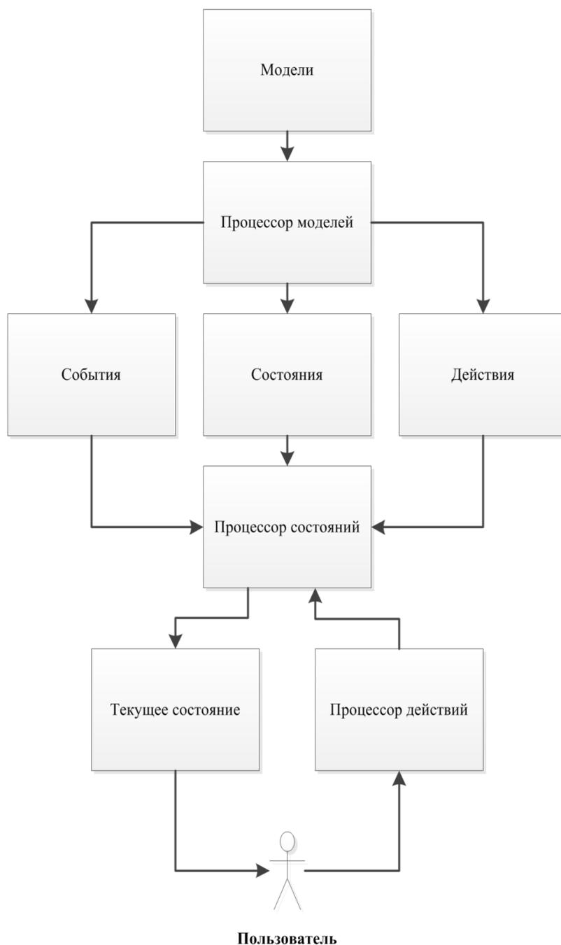
Рис. 1. Структура промышленного виртуального тренажера
