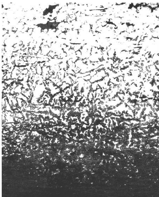
Рис. 2. Микроструктура образца № 6; б) поверхность – 330 кг/мм 2 ;
